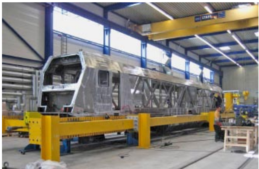
Bild 13: Prüfaufbau zum statischen Druckversuch
