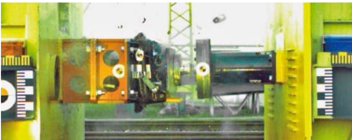
Bild 6: Deformationsverhalten des Deformationssystems DUPLEX G2.A2 für verschiedene Zeitschritte nach dem Aufprall auf eine Kraftmessdoseneinheit
