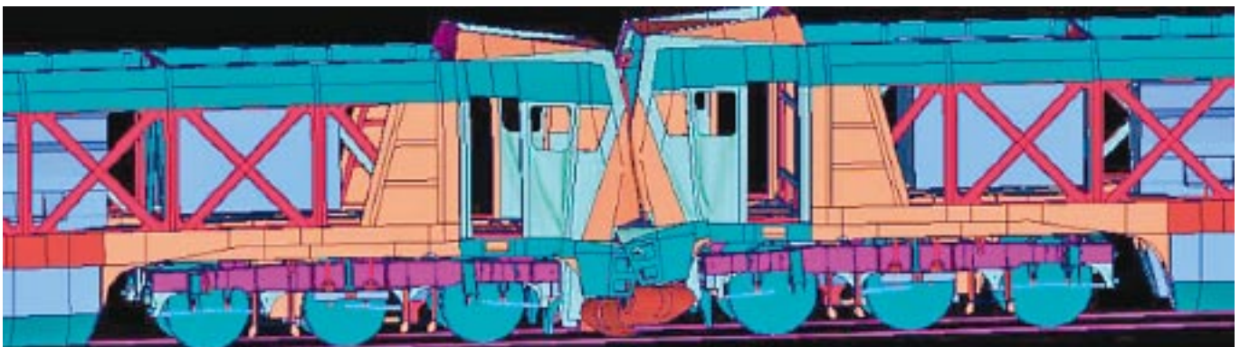
Bild 12: Kollisionsszenario 1 mit 40 mm Vertikalversatz bei 50 km/h Auftreffgeschwindigkeit
