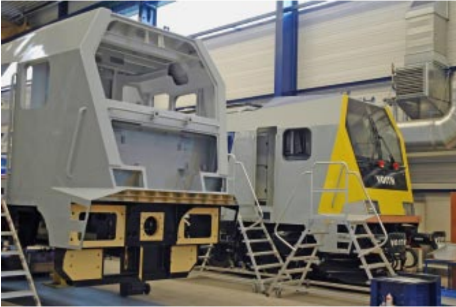
Bild 9: Aufkladderschutzeinrichtung sichtbar im Rohbau (links) und unsichtbar im Zustand nach Endmontage (rechts)
